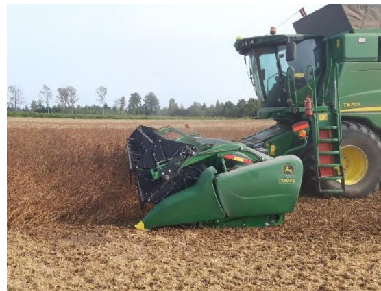
3. attēls. Sojas novākšana z/s ‘Rubulī’, izmantojot hederi ar daudziem izkopts segmentiem, kas kopē lauka virsmu, 26.09.2020
